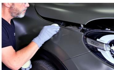
Si deve evitare di strofinare ad alta pressione per rimuovere qualsiasi contaminazione sulla superficie opaca, in quanto ciò provoca macchie con aumento della lucentezza che non possono essere annullate.
