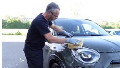
Le finiture opache richiedono una manutenzione particolare rispetto ai rivestimenti tradizionali che utilizzano una vernice trasparente lucida. Il trattamento convenzionale, comune e normale di questo speciale rivestimento può causare danni irreparabili alla superficie opaca. Le presenti linee guida aiutano il proprietario dell'auto ad utilizzare la cura corretta e appropriata per mantenere la finitura opaca in condizioni uniformi e impeccabili nel tempo.
