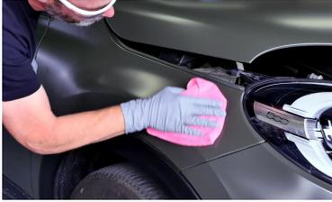
Leichte Oberflächenstörungen, Mikrokratzer oder Fingerabdrücke, die beim Zusammenbau von Teilen mit frisch applizierter Mattlackierung entstanden sind, können durch Aufsprühen von 3M Glasreiniger 08631 oder 3M Finish Control Spray 55535 auf die betroffene Fläche und Abwischen mit einem sauberen Microfasertuch entfernt werden. Berühren Sie die frisch applizierte Mattlackierung nicht bis sie nicht vollständig trocken und abgekühlt ist.
