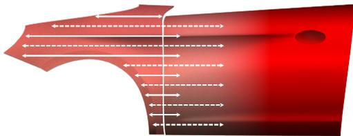
Utilize a técnica de disfarce na Base Bicamada conforme recomendado na respectiva FT da qualidade Cromax Base Bicamada. Evaporar ou secar a Base Bicamada conforme recomendado na FT.
