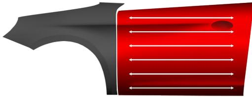
Painel adjacente: lixar o painel com o abrasivo adequado, p. ex. Trizact - P1000
